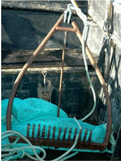
Figura 3. Arte de pesca (ganchorra) utilizada na recolha das amostras.
