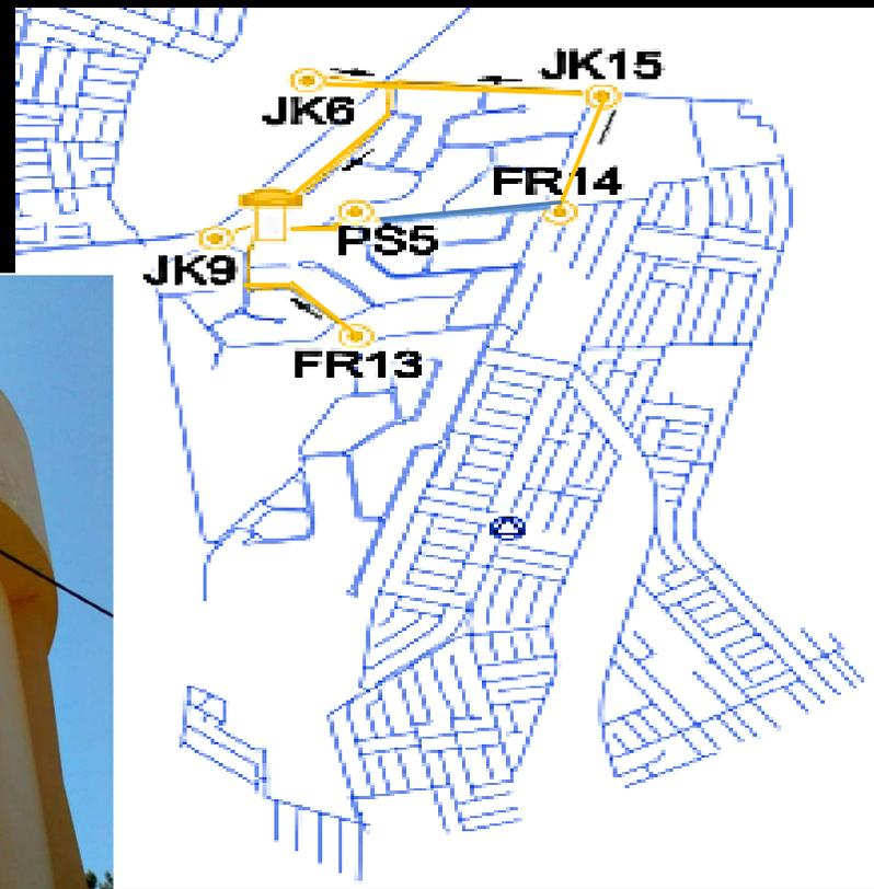
O sistema de abastecimento atual, integra um reservatório elevado, em funcionamento desde 1976, com 700 m<sup>3</sup> de capacidade de armazenamento, uma estação elevatória e seis captações de água subterrânea
